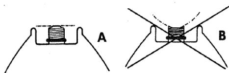
**BRĪDINĀJUMS:** Gāzes regulatoru uz GĀZES cilindra (sarkanais balons) grieziet, **nevelkot ar spēku**. Divas blīves (viena uz cilindra un viena uz regulatora) nodrošina pilnīgu blīvējumu. Pārmēriga pievilkšana izraisa vārsta
